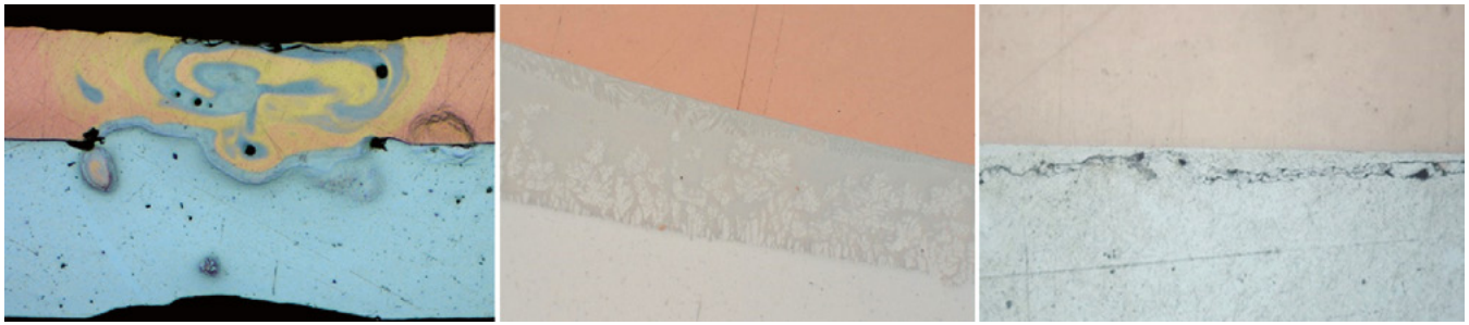
BILD 1 Gegenüberstellung von Kupfer-Aluminium-Fügeverbindungen mit Defekten (links), mit intermetallischer Phase (Mitte) und ohne Übergangsphase (rechts) (© Kern Liebers)
